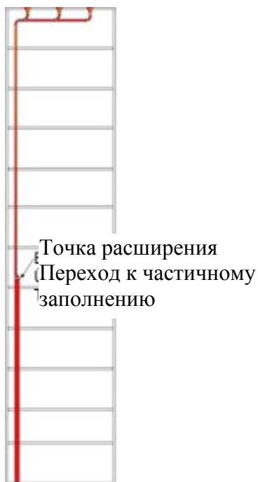
Рис. 10: Ограниченная высота самотечного водовода
